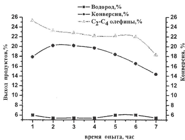
Рис.3. Длительные испытания 5%Cr/SiO 2 – нанокатализатора при превращении СНГ, обогащенного пропаном, в отсутствие паров воды (t он = 600°C, V об = 600ч -1 )
